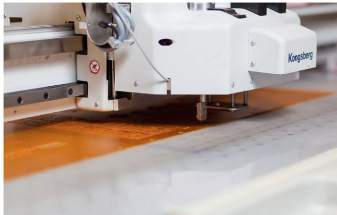
Konfektionierung von Flexo-Druckplatten
